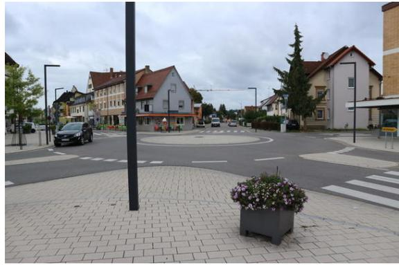
Bild 4: Mengen am Donauradweg bei Geo 48.05146 9.33311: Beispiel Minikreisverkehr, der auch für den RV gut durchfahrbar ist. Es gibt ein klar erkennbare große Mittelinsel, die für LKW überfahrbar ist.
