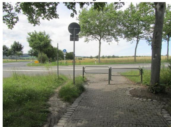
Bild 4: Blick auf die vor allem bei Dunkelheit schlecht sichtbaren "Drängelgitter". Da die Gitter ferner zu eng stehen, umfährt der RV die Gitter links.
