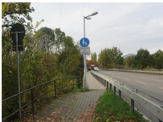
Bild 3: Auf dem stark beengten Gehweg im Brückenbereich ist noch nicht einmal Begegnungsverkehr von z. B. zwei Kinderwagen möglich.
