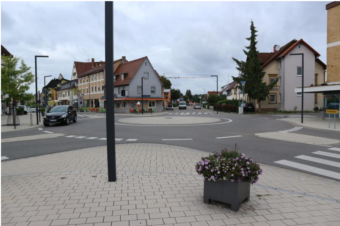
**Abbildung 3.7** Kleinerer Kreisverkehr mit überfahrbarer Mittelinsel am Donau-Radweg bei Mengen (Geo 48.05147 9.33309). Durch die Pflasterung und ein niedriges Bord ist die Mittelinsel klar erkennbar. in Heiligenrode würde die Insel natürlich wohl kleiner ausfallen. Für den Fußverkehr gibt es hier in Mengen Zebrastreifen. Bild: Dirk Schmidt 09-2017
