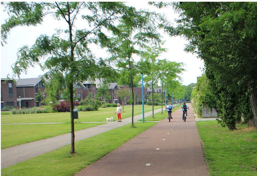
**Abbildung 4.9** gepflegter Grünzug mit quartiersübergreifender Nahmobilitätsverbindung in Enschede / Niederlande: als Separationselement zwischen Zweirichtungsradweg und Gehweg dient ein Grünstreifen mit Baumallee. Bild: Dirk Schmidt 06-2015.
