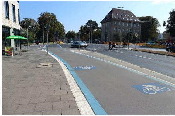
Bild 4: Göttingen 2018: - eRaschnellweg: hochwertige Gestaltung mit Asphalt im Seitenraum. klare Separation RV & FV durch unterschiedliche Oberflächen und klar erkennbare, weiße taktile Formsteine bzw. blaue Randmarkierung.
