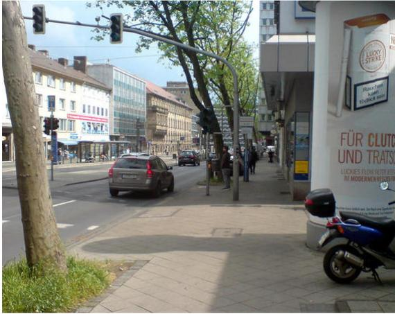
Bild 3: (Bild 2): Blick Gehweg Fünffensterstraße: Kein Hinweis auf den von rechts querenden Radverkehr! die Fahrradampel wird von der Litfasssäule komplett verdeckt. In Gegenrichtung verdeckt die Hausecke die RV-Querung.
