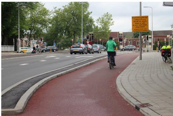
Bild 3: Utrecht: geschützte Radspur mit klarer Trennung zum Gehweg und Hochbord zur KFZ-Fahrbahn.
