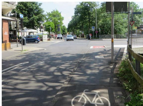
Bild 2: Knoten Eisenschmiede / Fiedlerstraße von Norden kommend: rechts der neue Radtaster für die Ansteuerung der Fußgängerampel. Er kann trotzdem keine Vollsignalisierung des Knotens für den RV ersetzen (Bild: H. Iba).
