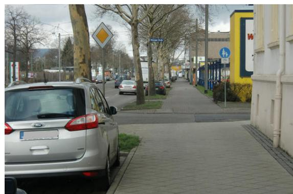
Bild 2: Leipziger Straße / Höhe Einmündung Melsunger Straße. Angebotsauswahl für den RV: Gehweg "Radfahrer frei" mit schwer einsehbaren Einmündungen und Einfahrten, oder stark befahrene KFZ-Fahrbahn (Bild: H. Iba).
