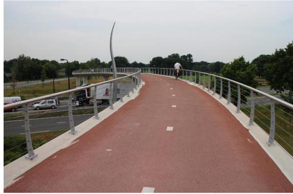
Bild 4: Auf dem Bauwerk: 4 m breite Fahrbahn, allerdings recht niedriges Brückengeländer (wohl keine 1,3 m, wie es in Deutschland Pflicht ist). Details zu dieser Brücke siehe auch Anlage "Handbuch System Radverkehr" -> Abschnitt "Brücken" bzw. oben verlinktes PDF.
