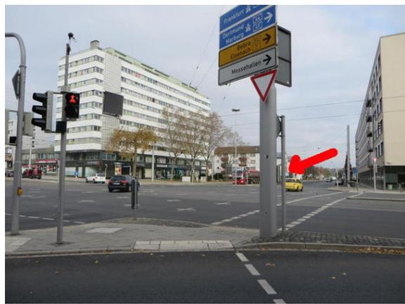
Bild 2: 1. kleine Verkehrsinsel; 2. verdeckte Fahrradampel für die Radverkehrsfurt Leipziger Straße. Selbst auf der Verkehrsinsel muss man als Ortsfremder die Fahrradampel erst einmal hinter dem Schildermast suchen (Bild: H. Iba 2016).
