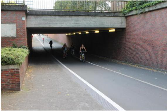
Bild 3: Münster - Unterführung Mauritztor: Das gerade angelegte und damit sozial sichere Bauwerk besitzt getrennte Bereiche für den RV und FV (mit taktiler Trennung).
