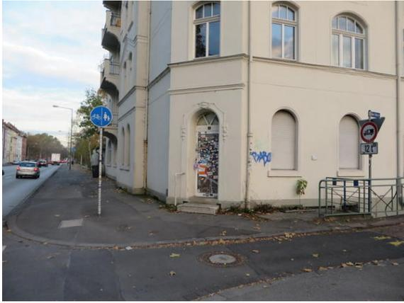
Bild 3: 2017: Schützenstraße Höhe "Am Wehr" mit Blickrichtung Hafnbrücke: Nach Verkehrszeichen als getrennter Geh- und Radweg gewidmet, obwohl keine Trennung erkennbar. Ferner fehlt vorne eine am besten rote gefärbte Furtmarkierung (Bild: H. Iba). Hinweis 04-2019: Schilder wurde in Zeichen 240 geändert; Furt fehlt weiterhin.
