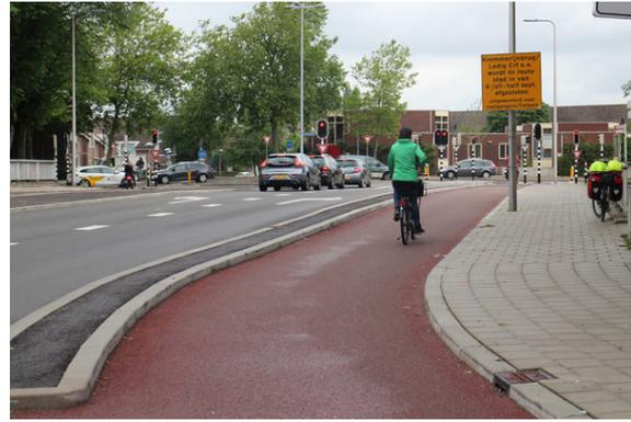
Bild 4: Utrecht: geschützte Radspur mit klarer Trennung zum Gehweg und Hochbord zur KFZ-Fahrbahn.
