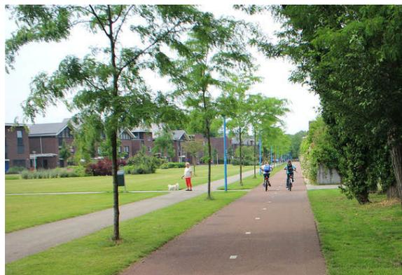
Bild 2: Gepflegter Grünzug mit Nahmobilitätsverbindung in Enschede / Niederlande: als Separationselement zwischen Zweirichtungsrادweg und Gehweg dient ein Grünstreifen mit Baumallee (Symbolbild).
