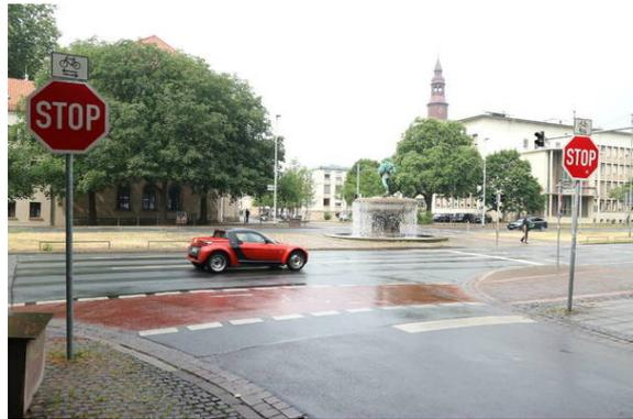
Bild 2: Symbolbild gute Furtmarkierung: Hannover -> Diese Furtmarkierung eines Zweirichtungswegs wurde rot eingefärbt und ist zusätzlich mit Radpiktogrammen versehen.
