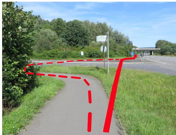
Bild 2: Links die Einmündung der untergeordneten Nürnberger Straße. Diese Radverkehrsführung ist nicht nur unkomfortabel, sondern auch für den Radfahrer gefährlich, da er seine Aufmerksamkeit mehr den Kurven widmet als dem Querverkehr. Eine direktere Radverkehrsführung ist sicherer.
