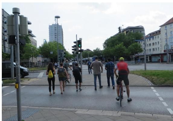
Bild 3: Radfahrende nutzen heute zum Teil die Fußgängerfurt an der Ampel mit, obwohl dies nicht vorgesehen ist. Im Verlauf der Raddirektroute ist links des Bildausschnitts daher eine eigene, baulich getrennte Ampelfurt für den Radverkehr anzulegen.
