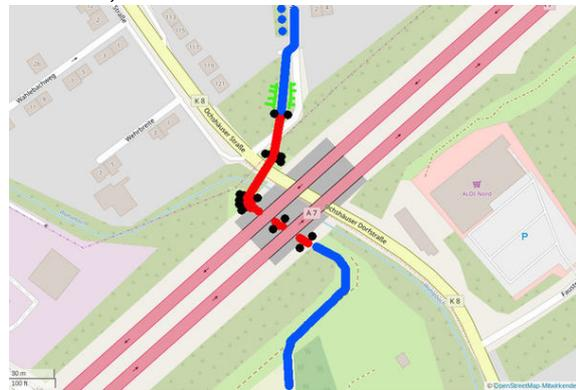
Bild 4: Prinzipskizze der Brücke: rot = Brückendeck, schwarz = Auflieger/Pfeiler. blau = Routenverlauf der Radpendlerroute
