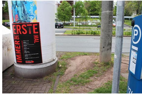
Bild 4: Mit der Einrichtung des Rasengleises wurde im Frühjahr 2017 mal eine Querungshilfe installiert; allerdings leider erstens mit Hochbord und zweitens in direkter Linie mit Parkplätzen bzw. einer Litfaßsäule und einem Glascontainer.
